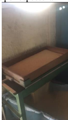
Figura 10 - Peneira automática que separa a farinha por espessura
