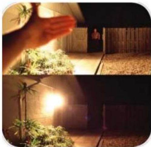
Figura 4a - Com o ofuscamento causado pela lâmpada, a pessoa no portão se torna invisível.
