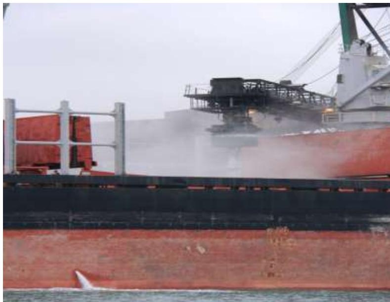
**Figura 1 - operação com granéis sólidos e emissão de material particulado (observar a nuvem de poeira sobre o armazém do navio)**
